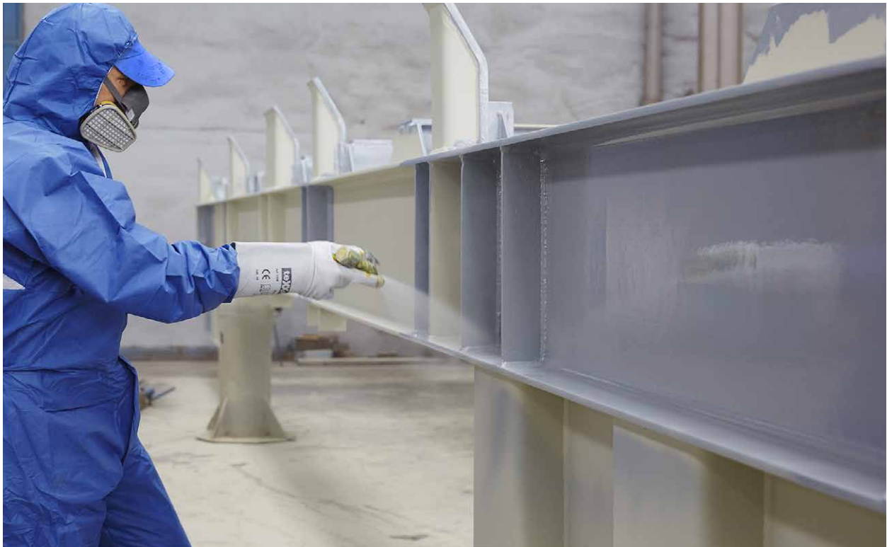
Produktion und Beschichtung von Stahlbauteilen für Hafenanlagen, Stettin (Polen)
